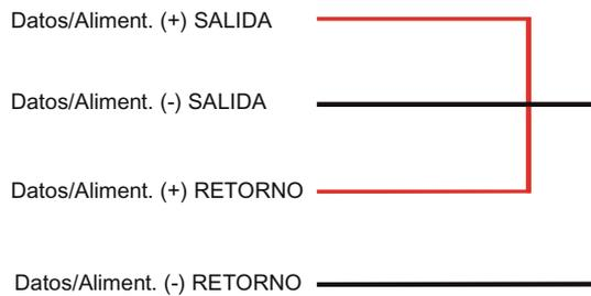
Figura 14 – Conexión del lazo – lazos no utilizados
